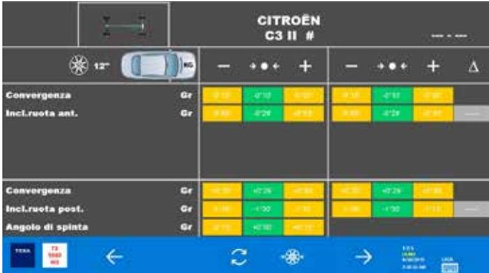
Während der Kontrolle der Achsgeometrie erlaubt die Software die Eingabe der Reifendurchmesser und zeigt den Sollbereich der Spurwerte, Halbspur und Fahrachswinkel an.
