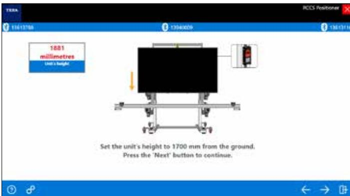
Die Vorrichtung muss elektrisch verstellt werden, um sie in der richtigen Höhe zu positionieren.
