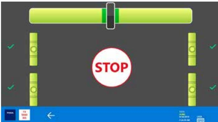
Die 4 CCD Sensoren müssen parallel zur Arbeitsfläche positioniert werden, das Lenkrad muss zentriert sein. Sind diese Bedingungen erfüllt, zeigt die Software "STOP".
