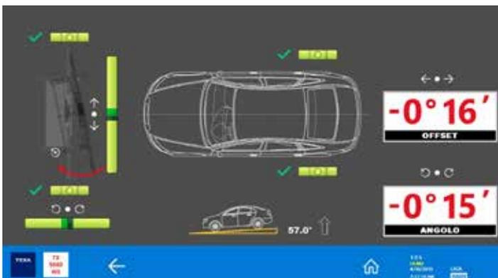
Die Anzeige "OFFSET" zeigt an, wenn sich das RCCS 3 EVO außerhalb der Fluchtung mit der Fahrzeugmitte befindet. "ANGOLO" hingegen zeigt an, um wieviel Grad die Struktur zur Fahrachse verdreht steht.
