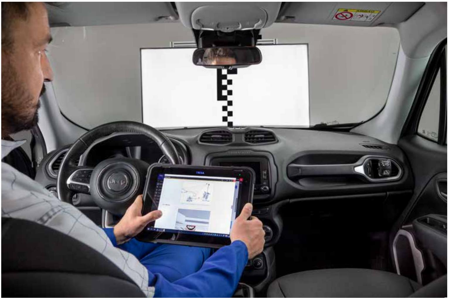
Die **Abbilder** der Kalibriertafeln werden entsprechend der getroffenen Fahrzeugauswahl **automatisch übertragen und positioniert**. Die Darstellung erfolgt durch einen linearen, sicheren und schnellen Prozess.
