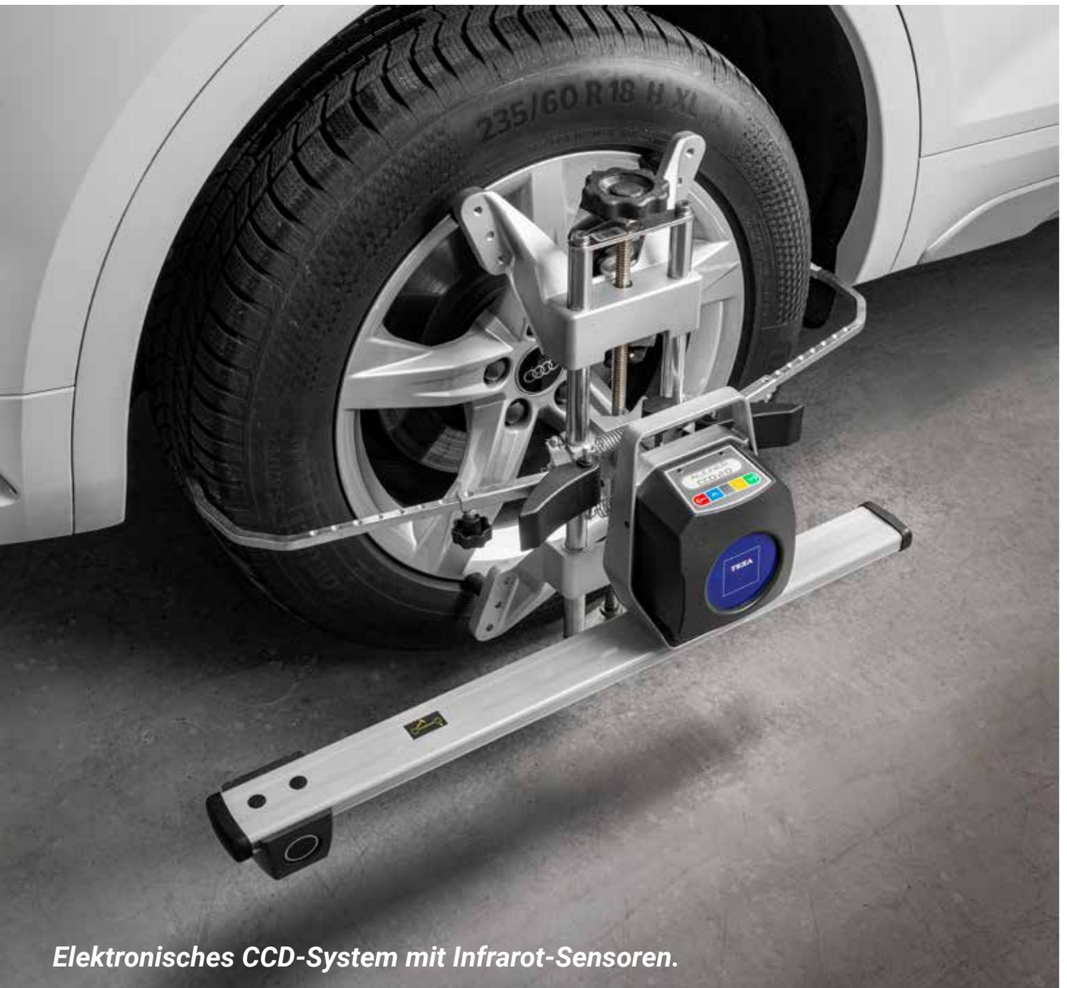
*Elektronisches CCD-System mit Infrarot-Sensoren.*
